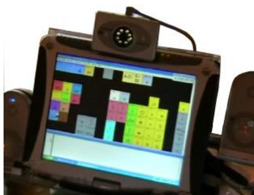
Bild 16 a–b. Samtalsdator med huvudstyrning och iPad med pekskärm
