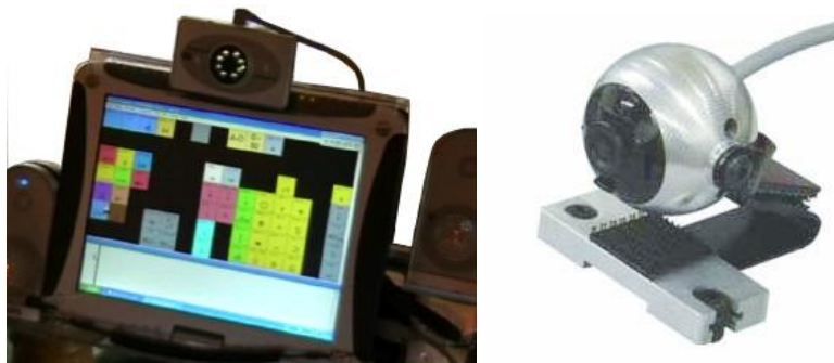
Bild 19 a–b. Huvudmus (mottagare) placerad på samtalsdator + liten modern modell av huvudmus 19 .
